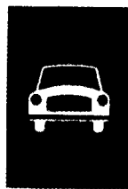
(Π - 26) Οδός ταχείας κυκλοφορίας.
