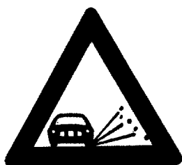
(K - 13) Επικίνδυνη εκτίναξη χαλίκων, (ασύνδετο αμμοχάλικο).
