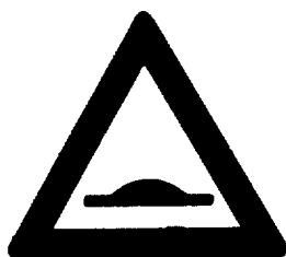
(K - 10) Επικίνδυνα υπερυψωμένο οδό- στρωμα η απότομη κυρτή αλλαγή της κατά μήκος κλίσης της οδού.
