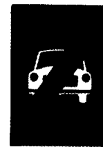
(Π - 26α) Τέλος οδού ταχείας κυκλοφορίας.
